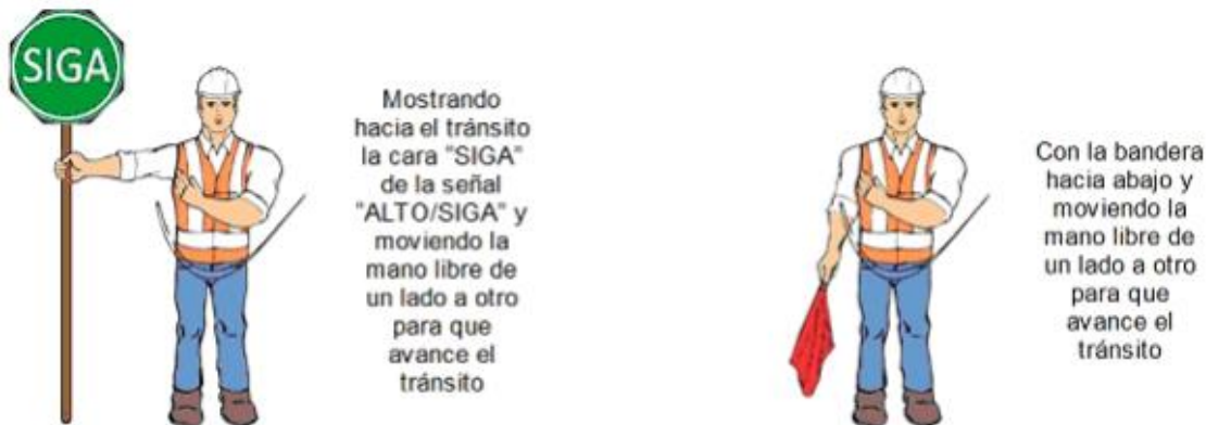
FIGURA 5.- Para que avance el tránsito
