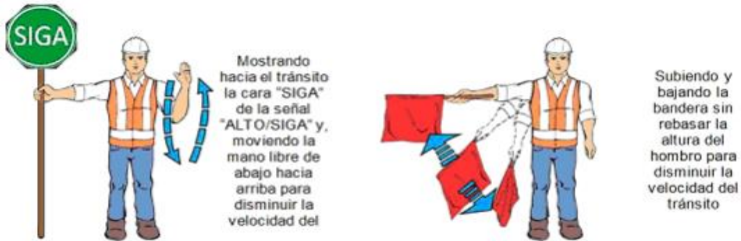
FIGURA 6.- Para alertar y disminuir la velocidad del tránsito
