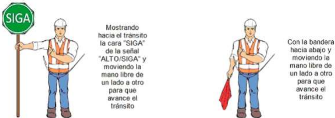
FIGURA 5.- Para que avance el tránsito
