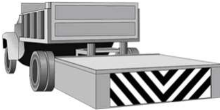
FIGURA 9.- Ejemplo de amortiguador de impacto móvil (OD-14/M)
