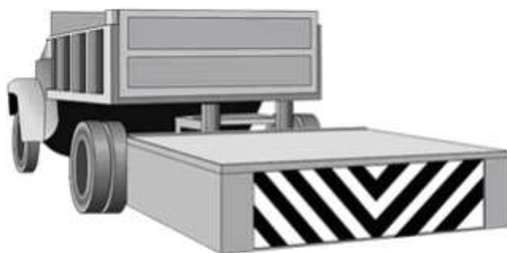
FIGURA 9.- Ejemplo de amortiguador de impacto móvil (OD-14/M)
