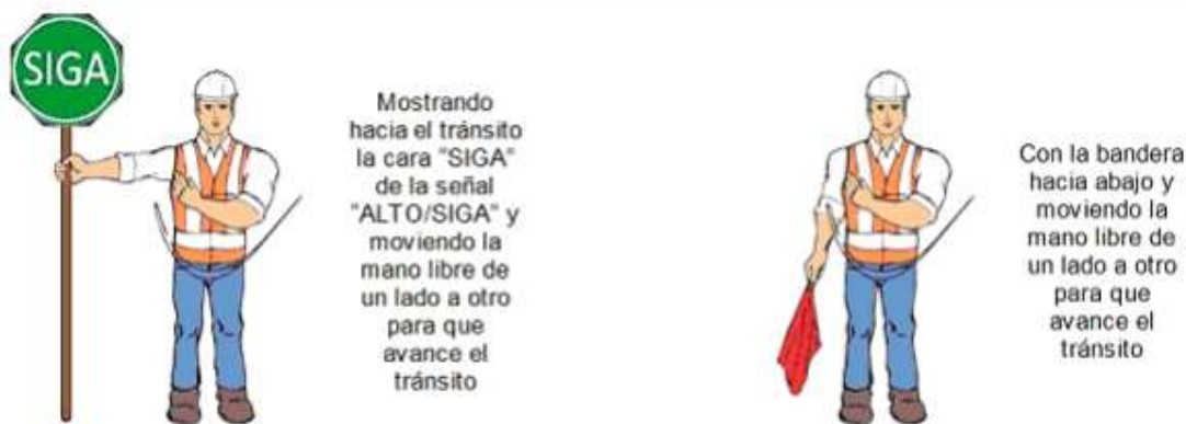
FIGURA 5.- Para que avance el tránsito
