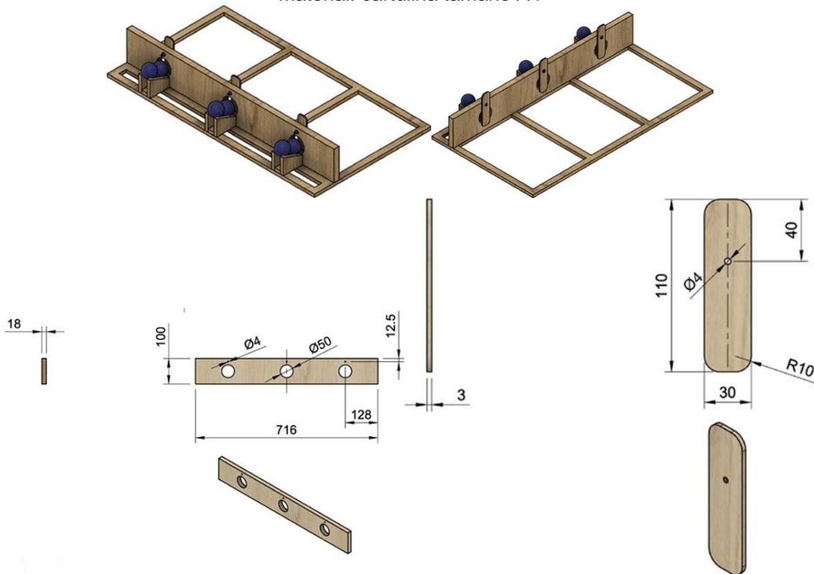
Requiere un tornillo M4 de 30 mm con una tuerca autoblocante y dos arandelas
