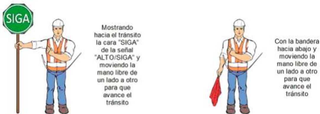
FIGURA 5.- Para que avance el tránsito
