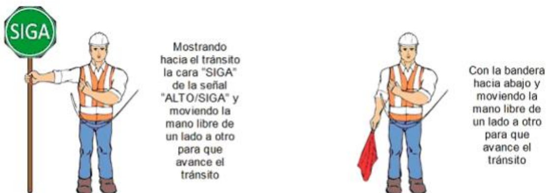
FIGURA 5.- Para que avance el tránsito
