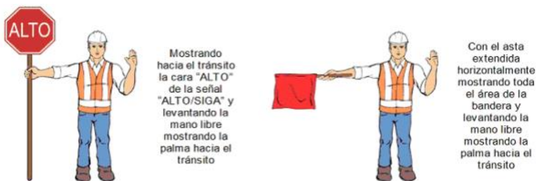
FIGURA 4.- Para detener el tránsito
