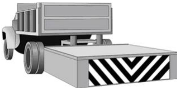
FIGURA 9.- Ejemplo de amortiguador de impacto móvil (OD-14/M)
